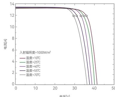
不同电池温度下电流-电压曲线图
